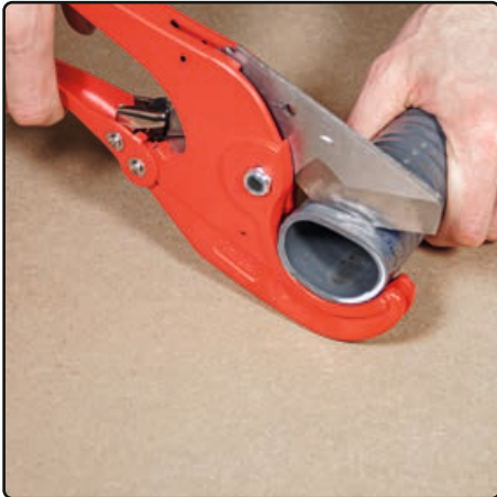
PVC - Flexschlauch gerade schneiden
