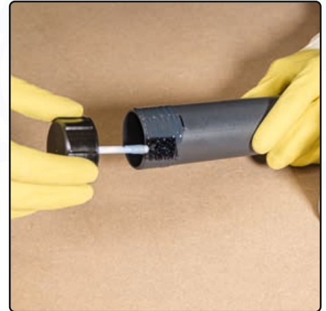
Kleber außen auftragen
