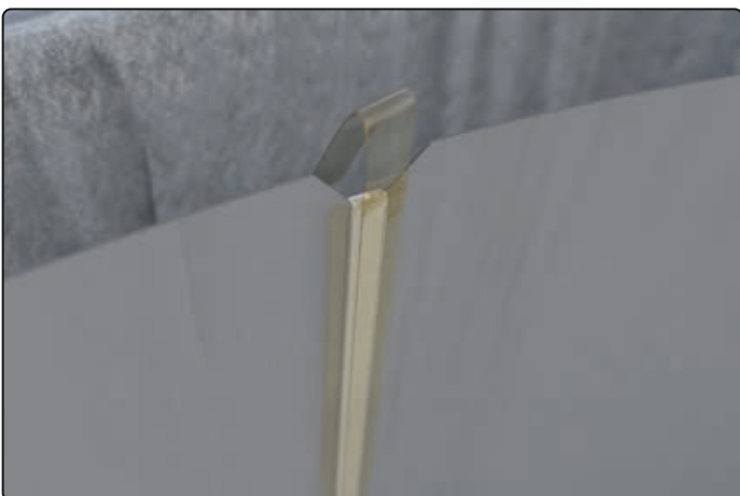
Scharfe Kante mit Klebeband abkleben
