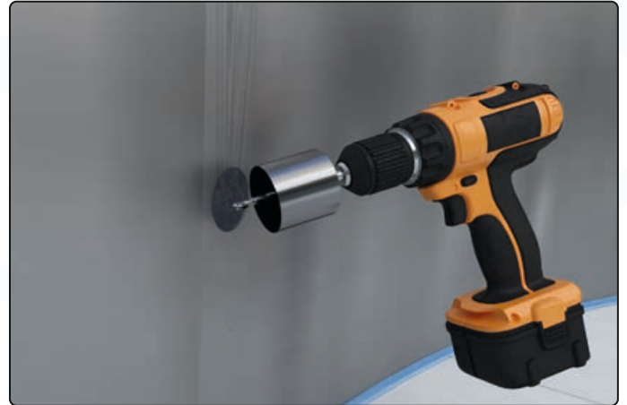
Loch anzeichnen und bohren
