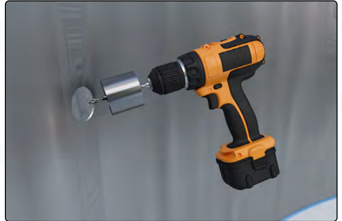
Loch anzeichnen und bohren
