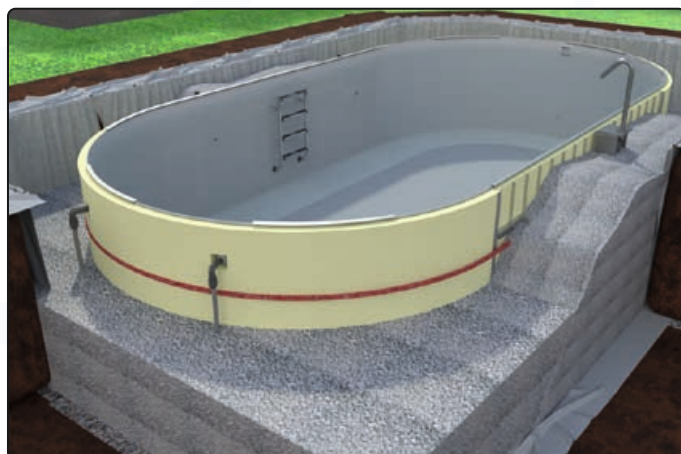
Kies gleichmäßig in der Baugrube einbringen
