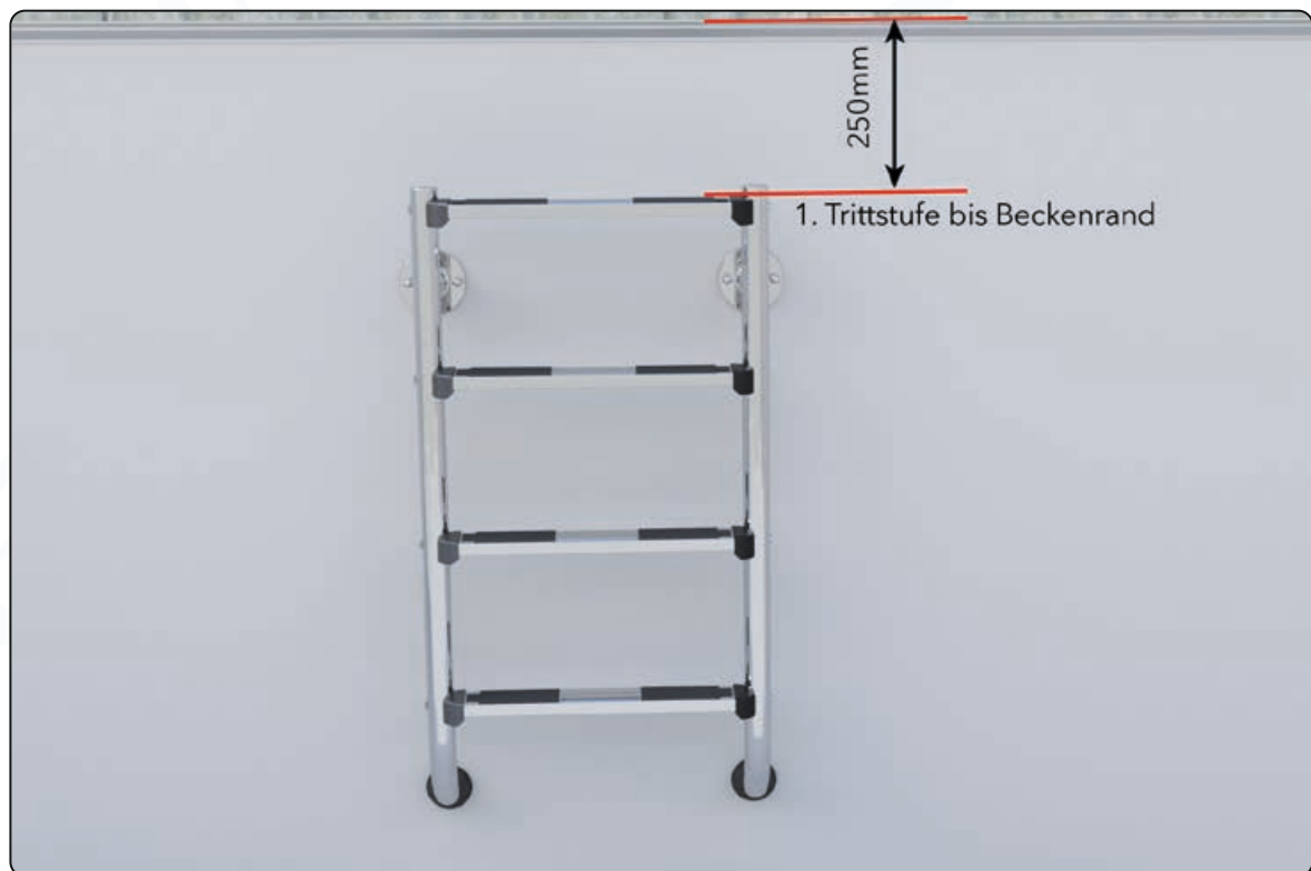
Einbauhöhe Zweiteilige Leiter
