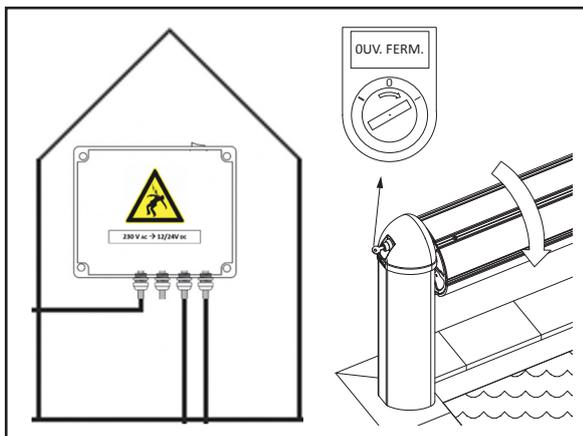
Die Abdeckung wird mithilfe einer Steuerung bedient, die mit einem Schlüssel oder einem Zugangscode verriegelt und in unmittelbarer Nähe des Schwimmbeckens angebracht wird.
